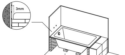
以水泥加強底座與浴缸底部之結構。
