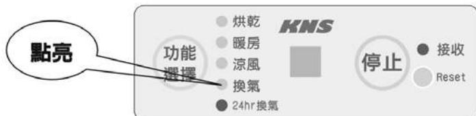
3.設定為換氣弱風模式，初設運轉定時3小時，同時換氣綠色LED閃爍(亮一秒滅一秒)。
