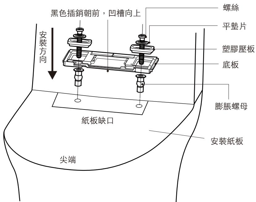
展開內附的安裝紙板，以尖端為準，與瓷器邊緣對齊後，平鋪在瓷器平面上，將底板安裝在紙板缺口上，底板與缺口對齊。
