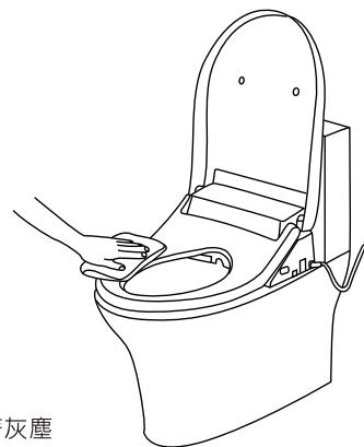
1. 清潔保養或檢查時，須將電源插頭從插座拔除，否則可能導致觸電或故障。請定期清除附著灰塵的電源插頭，請拔下插頭並使用乾布擦拭。拔插頭時，務必握著插頭本體，切勿拉扯電線，否則會造成電源插頭及電線受損。
