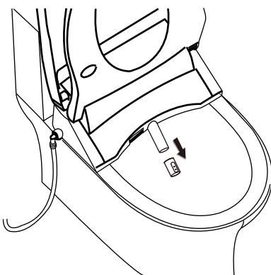
提醒：1. 清洗時不可拉扯噴桿，以免噴桿、主機損壞。
