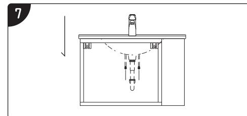
7. 將臉盆放置在浴櫃上並安裝排桿組和排水零件
