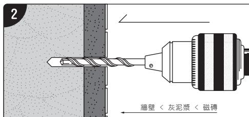
2. 利用電鑽與適當之鑽頭（同套筒尺寸）於牆面鑽出塑膠壁虎孔，並清出孔內碎屑。
