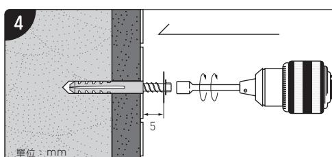
4. 利用電鑽與適當之鑽頭（同套筒尺寸）將六角螺絲鎖入塑膠壁虎內。
