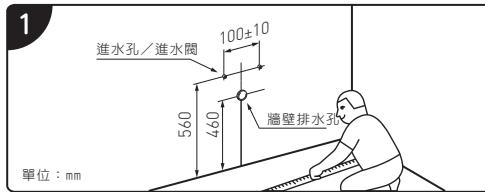
1. 將進水閥放水清除冷熱水管內雜質後，依使用者身高及使用習慣調整安裝高度。將浴櫃放到欲安裝位置，用水平尺校正水平位置後，用筆在牆上和地面上標出浴櫃及六角螺絲/塑膠壁虎的位置。
