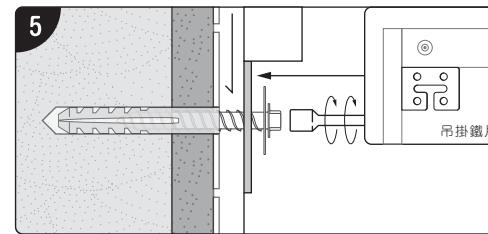
5. 將吊掛鐵片安裝在六角螺絲預留空間上，並確認浴櫃是否保持水平，確認完成後用電鑽與適當之鑽頭（同套筒尺寸）將浴櫃鎖固至牆面。
